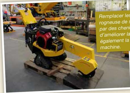
Remplacer les roues d'une rogneuse de souches par des chenilles permet d'améliorer la mobilité, mais également la stabilité de la machine.
