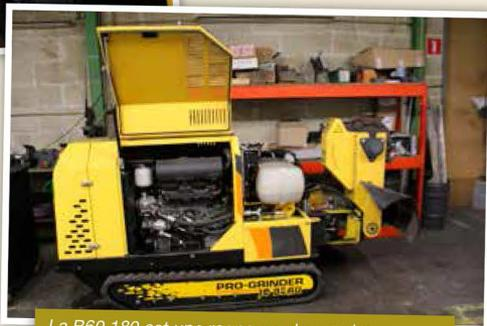
La B60 180 est une rogneuse de souches entièrement automatique sur chenilles et à commande à distance. Elle est pour le moment encore à l'état de prototype.
