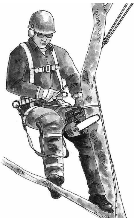
Illustration n° 27 Démarrage dans l'arbre d'une scie à chaîne d'élagueur
