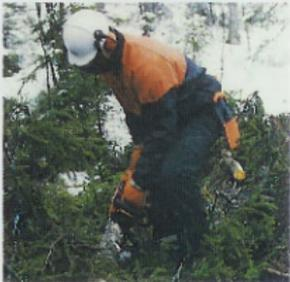
1. Utilisez la partie de la chaîne en traction et opérez en reculant progressivement le guide-chaîne reposant sur le tronc.
