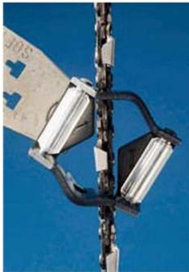
Positionner le calibre comme le montre la figure. Les flèches du calibre doivent pointer dans le sens de coupe de la chaîne. (Vers l'avant).
