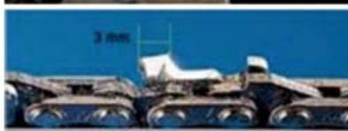
Il est temps remplacer la chaîne. Une gouge de chaîne ne doit jamais avoir une hauteur inférieure à 3 mm.
