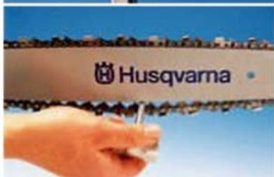
Si la chaîne tendance à « déraiper », la tendre au moyen de la vis de réglage ou la bloquer en introduisant la clé universelle entre le guide-chaîne et la chaîne comme le montre l'image.
