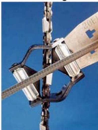
Retourner le calibre et limer dans l'autre sens. Faire avancer la chaîne au fur et à mesure.
