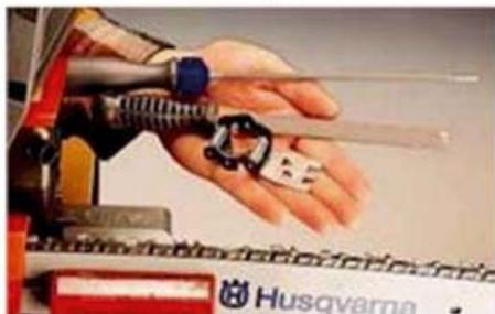
Pour entretenir la chaîne, on a besoin de: une lime plate, une lime ronde et un combiné calibre-jauge pour la gouge et le talon de profondeur. Contacter votre revendeur Husqvarna pour une recommandations sur les outils corrects pour affûter votre chaîne.
