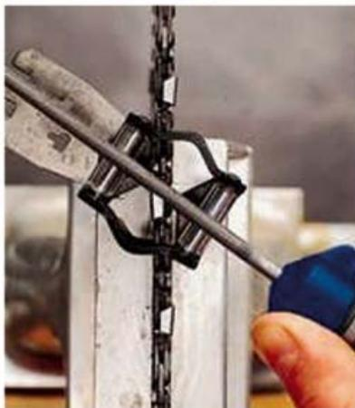
Appuyer la lime sur les rouleaux du calibre et affûter en poussant la lime. Le même nombre de coups de lime sur toutes gouges.
