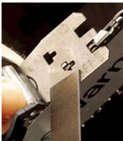
Affûter le talon avec la lime plate jusqu'au calibre.
