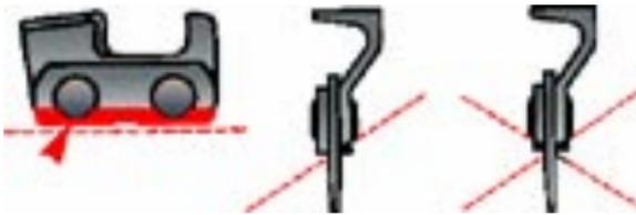
Martèlement à la base des gouges et des maillons attaches (Remède voir J)
