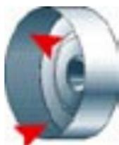
Usure excessive à l'intérieur de la cloche d'embrayage
