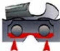
Martèlement des bases des gouges et des maillons attachés. (**Remède** voir **Q**)
