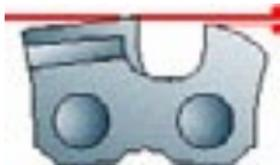
.025" (0.64mm) Réglage des limiteurs de profondeur
