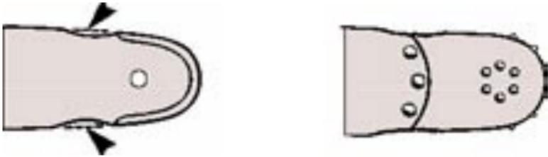
Eclats sur le rail ou usure importante en bout de guide, au niveau de la jonction du nez remplaçable ou en bord de stellite.
