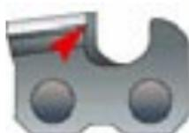
Angle de coupe de la platine supérieure pas assez prononcé;
