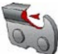
Gouges très endommagées sur le dessus des platines latérales et/ou supérieures.
