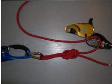
Ouvrir la flasque mobile et introduire la corde dans le descendeur.
