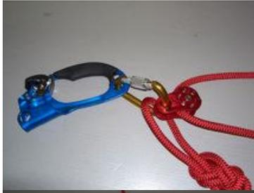
Mettre la poulie sur le mousqueton de la poignée et fermer la virole du mousqueton.
