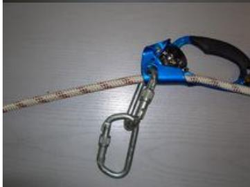
Verrouiller la poignée et la lester avec 2 mousquetons en acier pour permettre sa descente vers la victime.
